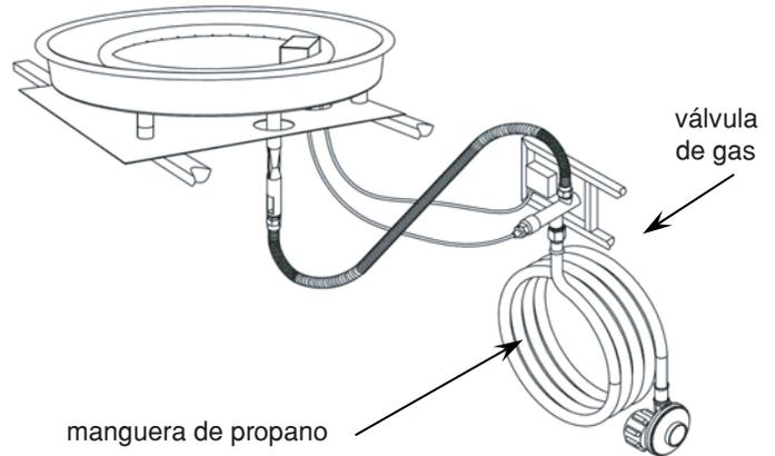
2. Desenrosque hacia la izquierda y desconecte los tubería corrugada del orificio del propano usando la llave inglesa, luego desconecte el orificio del propano del tubo de entrada. El orificio del propano está identificado con una marca roja.
