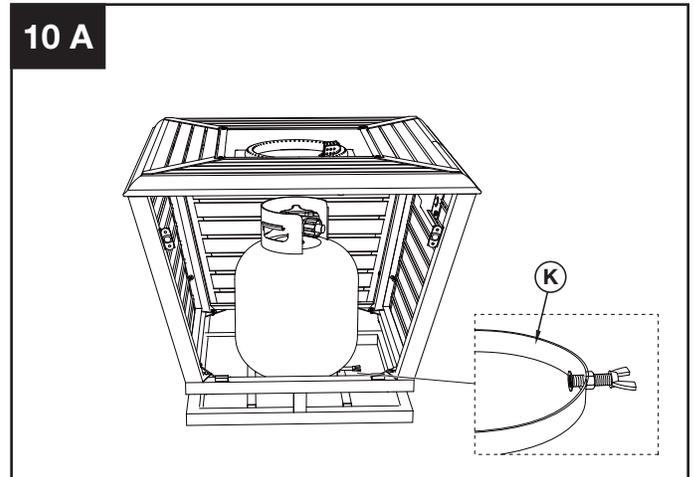
10 B. abroche la correa del tanque de propano y asegure el cilindro al apretar el tornillo en la placa inferior.
