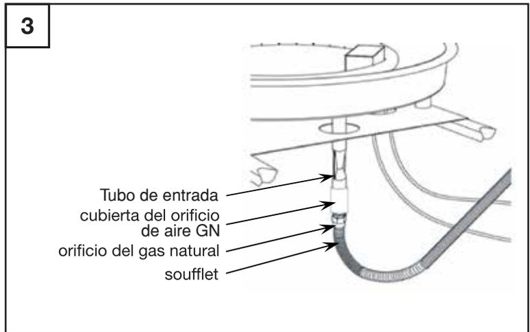
4. Conecte la manguera del gas natural con la válvula de gas al atornillar herméticamente hacia la derecha usando la llave dinamométrica o de torsión.
