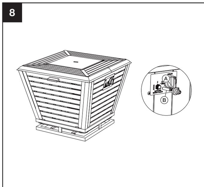
8. Instale la batería al encendedor electrónico (9) Quite la tapa de caucho en el encendedor electrónico (A) al desatornillar y deslizar la batería (B) dentro de la ranura de la batería. Asegúrese que el lado positivo de la batería mire hacia fuera. Atornille firmemente la tapa del encendedor electrónico (A) sobre la batería.
