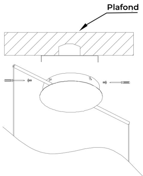
Fixez la coupole au support de montage (A) à l'aide des vis de la coupole (C).
